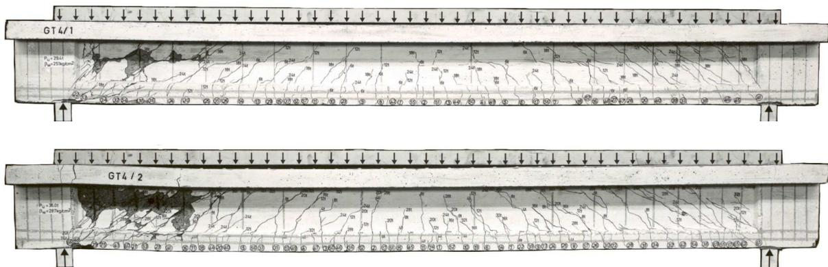
**Bild 3.10:** Stegdruckbrüche der Balken GT 4/1 und GT 4/2 aus [1.3]
