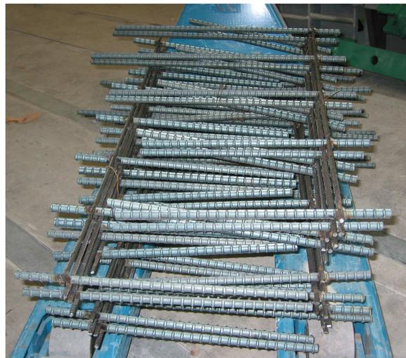
*Bild 2.10:* Leiterförmige (links) und kammförmige HFV-Querkraftbewehrung für Balken oder Platten
